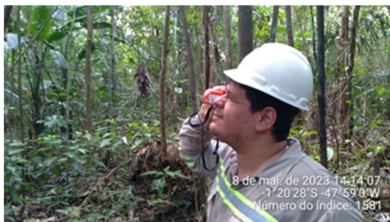
(c) Aferição da altura do fuste com clinômetro
