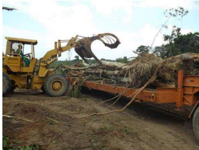
Figura 3.2-12 - (a) e (b) Enleiramento dos resíduos florestais;(c) secagem do material; (d) abertura das covas; (e) enterramento do resíduo; (f) compactação com terra sobre o resíduo.
