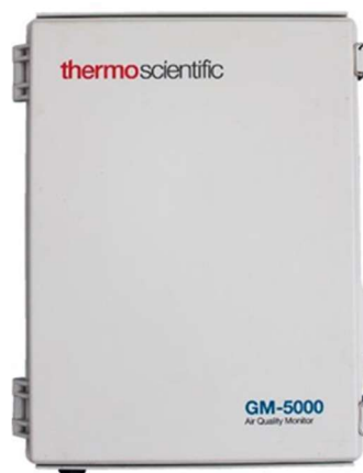
Figura 3.1-1 - Equipamento de monitoramento de gases poluentes e materiais particulados utilizado no presente estudo: Grid Monitor-5000.
