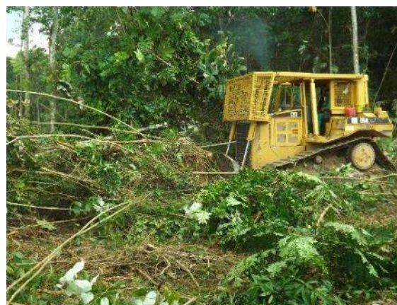
(d) Uso de trator de esteira em área de vegetação não arbórea
