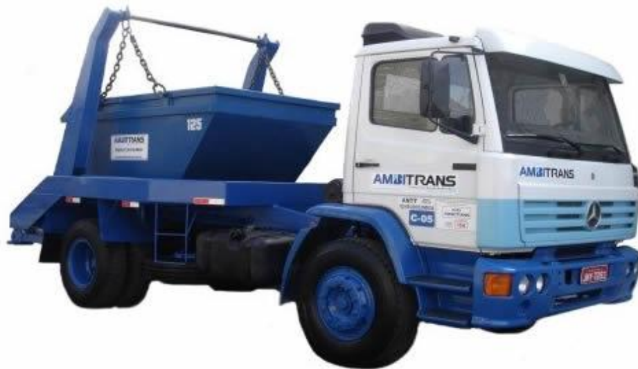
Figura 22 – Caminhão para transporte de resíduos de construção civil.
