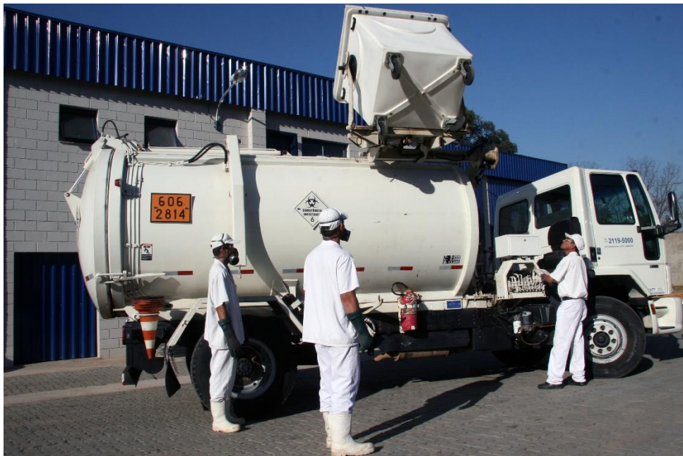
Figura 23 – Caminhão para transporte de resíduos perigosos.
