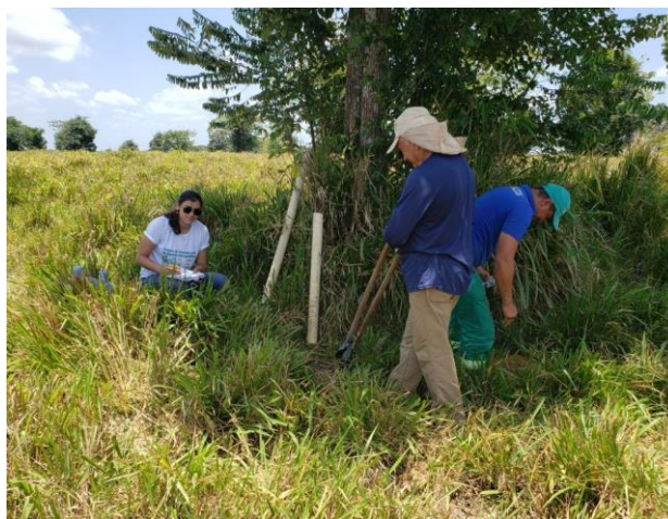
Foto 8: Execução do furo de trado para realizar teste de infiltração no ponto 21, Área 5.
