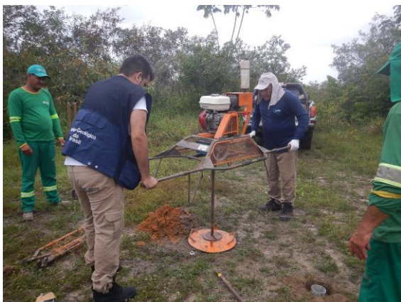
Foto 3: Execução do furo de trado para realizar teste de infiltração no ponto 1, Área 2.
