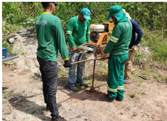
Foto 10: Execução do furo de trado para realizar teste de infiltração no ponto 14, Área 6.
