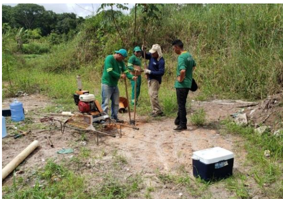
Foto 9: Execução do furo de trado para realizar teste de infiltração no ponto 13, Área 6.
