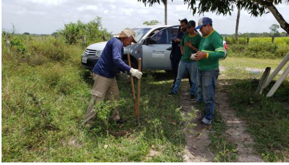
Foto 1: Execução do furo de trado para realizar teste de infiltração no ponto 9, Área 1.
