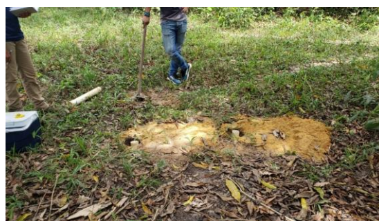
Foto 6: Furos de trado revestidos com tubos de pvc para realizar teste de infiltração no ponto 18, Área 4.
