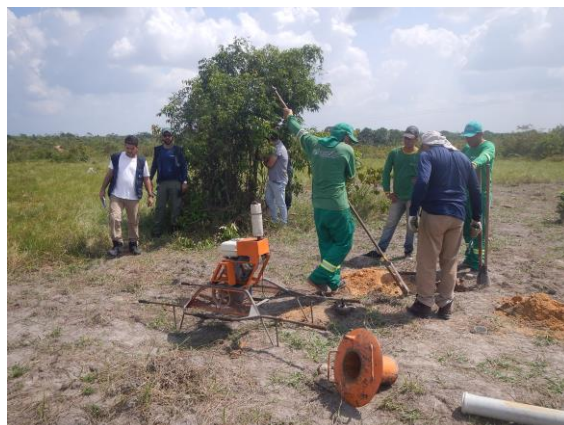
Foto 4: Execução do furo de trado para realizar teste de infiltração no ponto 2, Área 2.
