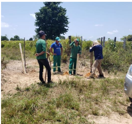
Foto 7: Execução do furo de trado para realizar teste de infiltração no ponto 19, Área 5.
